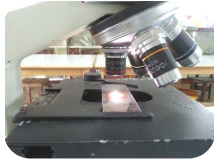
ภาพที่ 2.14 การหมุนปุ่มปรับภาพหยาบให้ลำกล้องเลื่อนลงจนเลนส์ใกล้วัตถุอยู่ใกล้กระจกปิดสไลด์ ที่มา : ปวีณกร บัวเพชร. 2555 : ถ่ายภาพ
