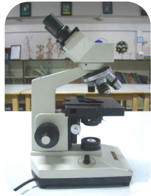
ภาพที่ 2.12 วิธีการหมุนเลนส์ใกล้วัตถุที่มีกำลังขยายต่ำสุดให้อยู่ในตำแหน่งแนวของลำกล้อง
