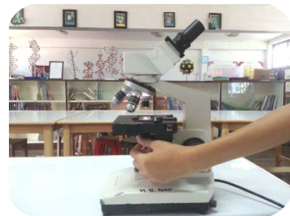
ภาพที่ 2.18 การหมุนก้านปรับไอริส ไดอะเฟรมเพื่อปรับแสง
