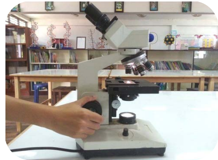
ภาพที่ 2.15 การหมุนปุ่มปรับภาพหยาบให้เลนส์ใกล้วัตถุเลื่อนห่างจากสไลด์ จนกระทั่งเห็นภาพ ที่มา : ปวีณกร บัวเพชร. 2555 : ถ่ายภาพ
